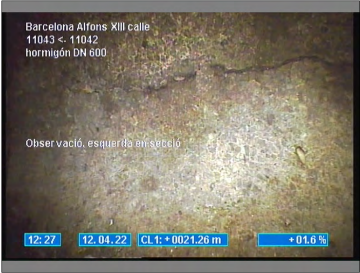
Foto: 5_6A 21,2m, Observació, esquerra en secció
